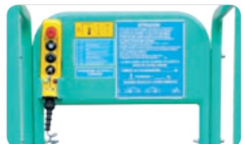
Herausnehmbare Druckknopfplatte zur leichten, sicheren Handhabung. Mit Schlüsselschalter und Schlagtaste.
