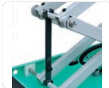
Sicherheitsstange zum Offenhalten der Schere bei Wartungsarbeiten.
