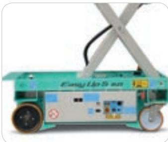
Schlaglochschutz – dicht an den Räder verschweißte Stahlschuhe.
