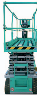
Neues Design der Arbeitsbühne und des Scherenpaketes
