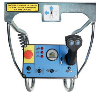
Robuster, einfacher und intuitiver Bedienpult auf der Plattform
