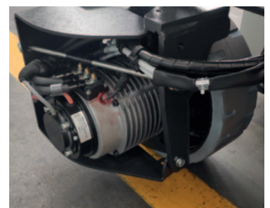
Wechselstrom-Elektromotor (AC). 90° Lenkung.
