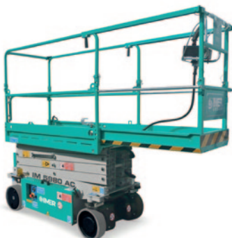
Manuelle Plattformverlängerung um 1.0 m
