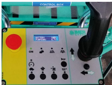
Bedienpult auf der Plattform mit Softtouch-Tastatur: einfache und sichere Verwendung
